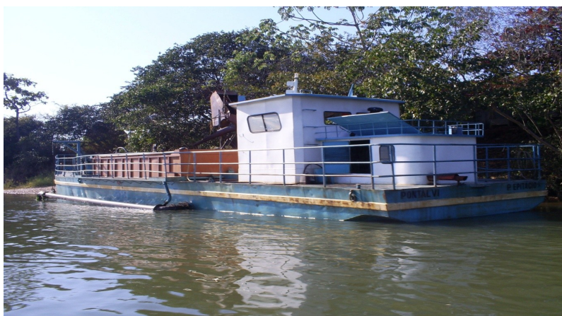
Figura 16 – Draga utilizada no processo de extração de areia no alto curso do rio Paraná. Foto: (NERY DOS SANTOS, 2007)
