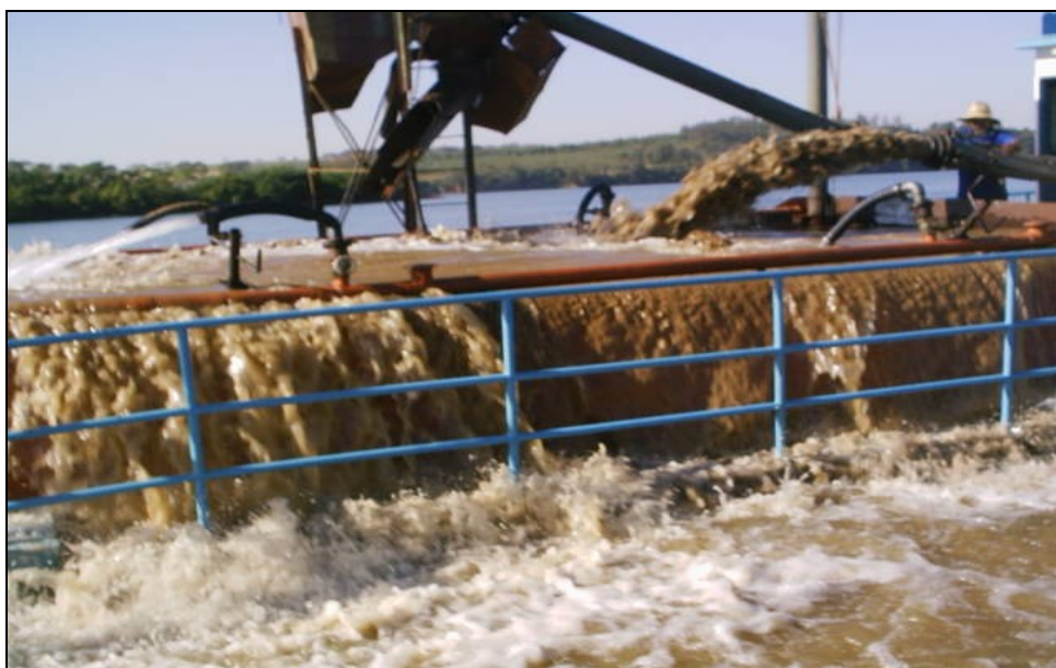
Figura 26 – Dragagem - Processo de extração de areia no canal do Rio Paraná. Foto: (NERY DOS SANTOS, 2007)
