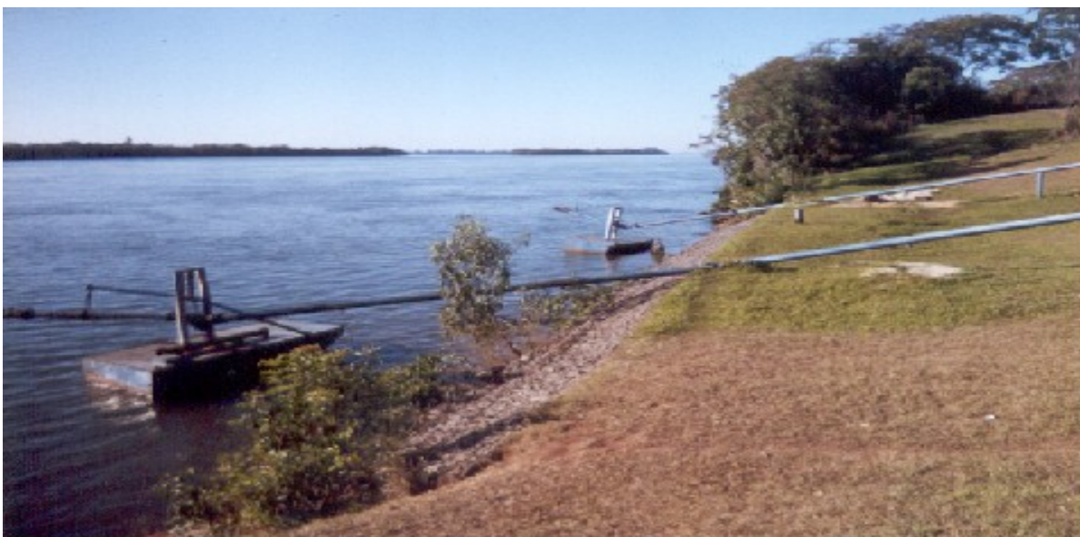
Figura 18 – Vista da tubulação nas margens do rio Paraná, que recebe a areia da draga. Foto: (NERY DOS SANTOS, 2007)
