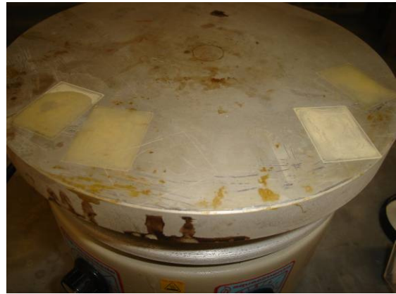
Figura 18: Lamínula com resíduo após evaporação da água destilada.
