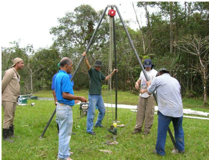
Figura 16: Cena de testemunhagem por vibrotestemunhador na Estação Ecológica Juréia-Itatins (Foto: Alethea Ernandes Martins Sallun).
