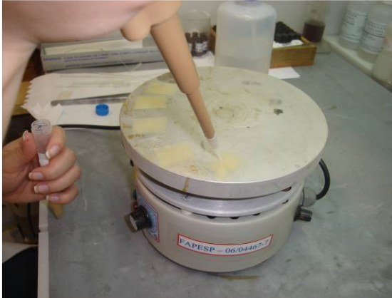
Figura 17: Micropipetagem do resíduo contido na água destilada sobre a lamínula.
