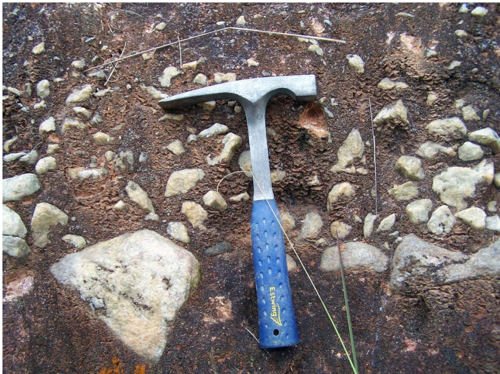
FIGURA 7.5– Foto em detalhe da cascalheira basal do depósito de terraço, com seixos de quartzo de dimensões e graus de arredondamento variados, imersos em matriz argilosa caulínica.
