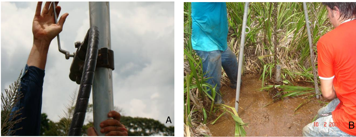
Figura 10: (A) Mangote vibratório ligado ao tubo; (B) Retirada do testemunho com talha e tripé.
