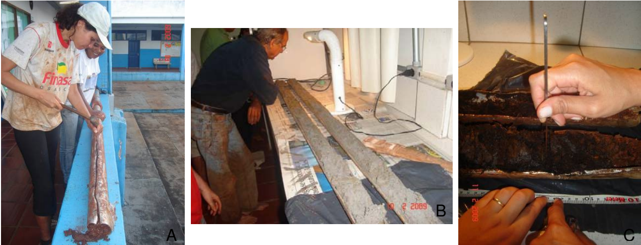
Figura 11: (A) Abertura do tubo; (B) Análise Estratigráfica; (C) Amostragem do sedimento.
