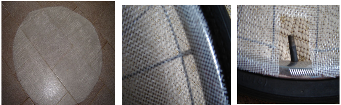
Figura 4: Recorte de nylon (sombrite) transparente sendo fixado no arame e deixando espaço para a válvula do pneu.
