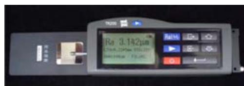
Figura 5. Perfilômetro utilizado neste estudo.
