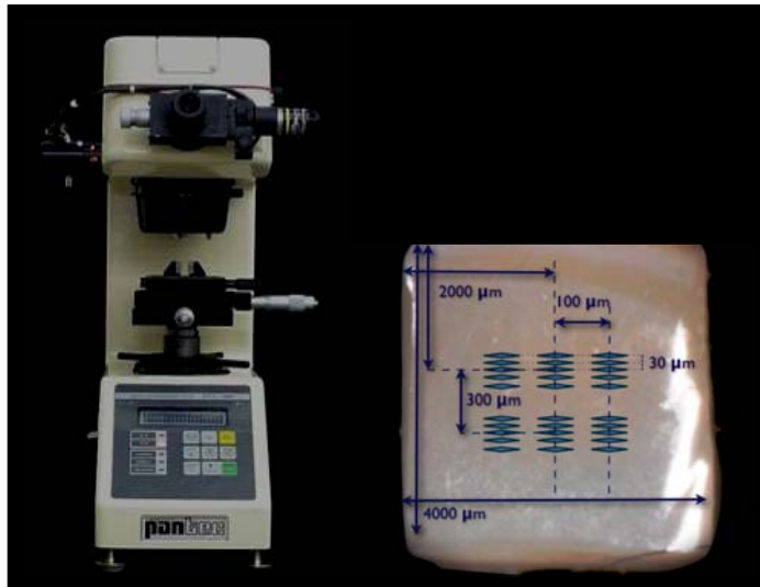
Figura 6: Microdurômetro usado no estudo e localização das indentações.
