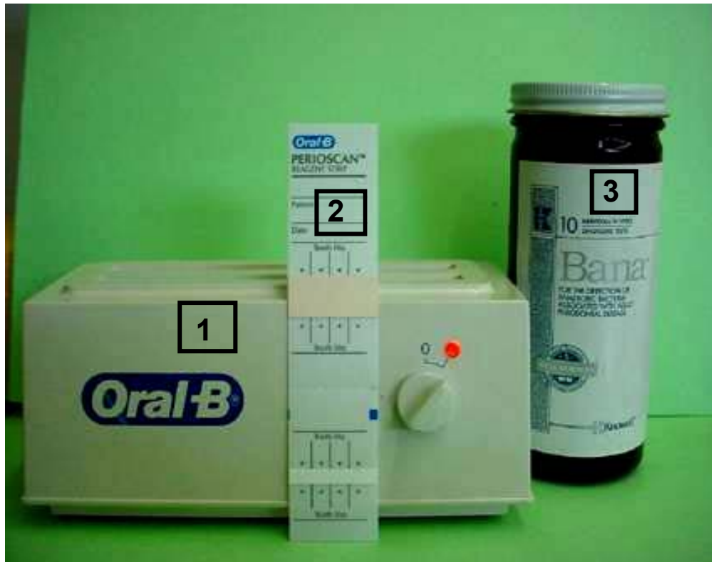
Figura 2: Foto ilustrativa dos componentes do teste BANA; 1-Incubadora; 2- cartão reativo; 3-Frasco para armazenamento de cartões.
