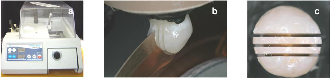
**Figura 3.19.** a) Cortadeira metalográfica; b) Cortes mesio-distais; c) Cortes por uma vista oclusal.
