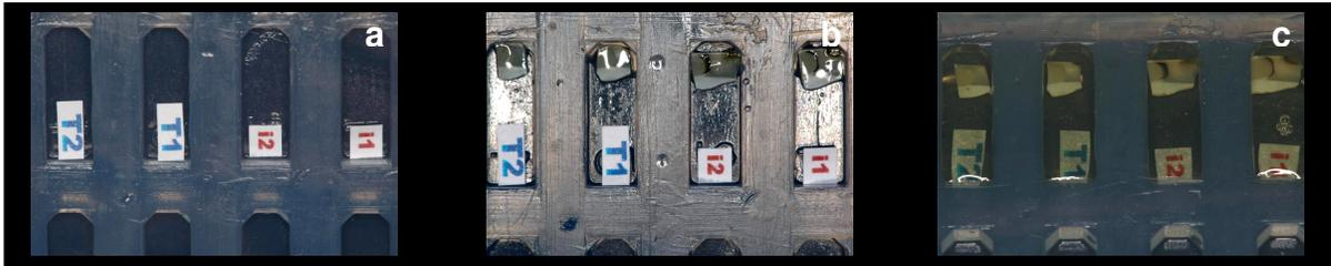
**Figura 3.25.** Seqüência para inserção no molde de silicone. a) Identificação; b) Inserção das amostras; c) Inserção da resina epóxica.
