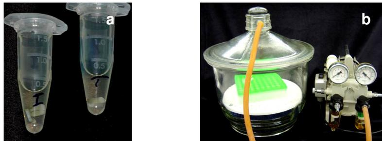
**Figura 3.24.** a) Amostras em resina epóxica 100%; b) Dessecador para a evaporação do óxido de propileno.
