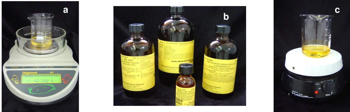
**Figura 3.23.** a) Balança digital; b) Constituintes da resina epóxica c) Agitador magnético
