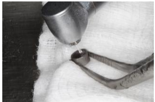
Anexo 6: Irradiação do titânio (SLA) com laser Er,Cr:YSGG com refrigeração ar/água 80%/20%.
