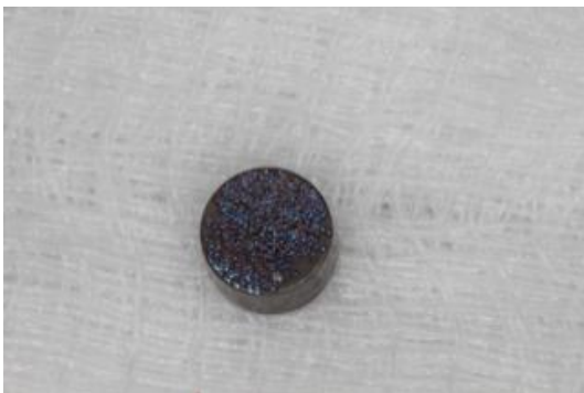
Anexo 7: Disco de titânio (SLA) após irradiação com laser Er,Cr:YSGG .
