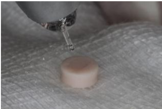
Anexo 5: Irradiação da zircônia (Y-TZP) com laser Er,Cr:YSGG com refrigeração ar/água 80%/20%.
