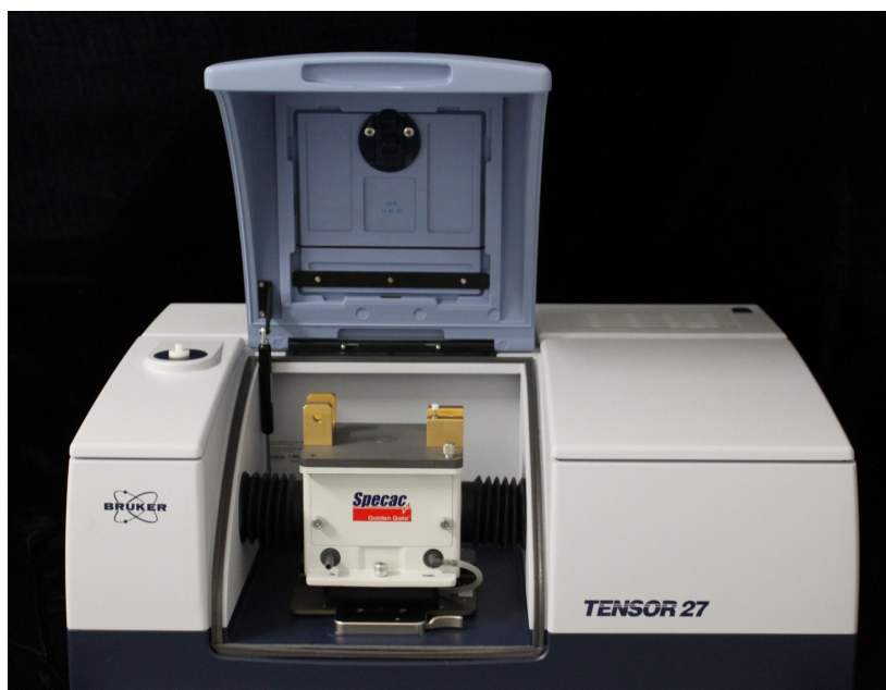
Espectrofômetro infravermelho com transformada de Fourier – FTIR (Tensor 27, Bruker Comp), unidade de reflectância total atenuada – ATR (Satandard Golden Gate, Specac).
