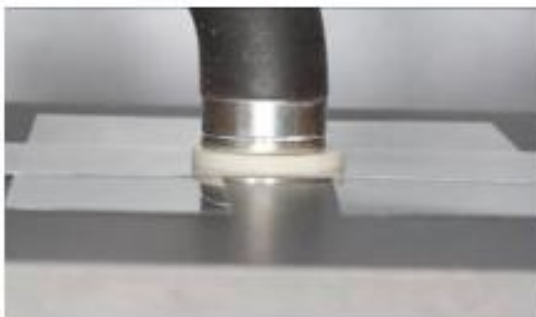
Fotoativação através de disco de cerâmica 1,5mm (e.max1,5).
