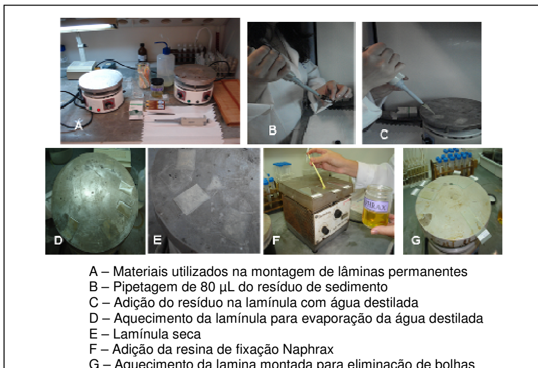
Figura 7 – Etapas de montagem das lâminas permanentes.
