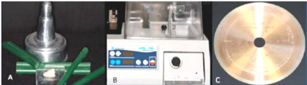
Figura 6 – A) Materiais utilizados para fixação do dente na placa de acrílico para secção das raízes; B) Cortadeira metalográfica (ISOMET 1000, Buehler, Lake Bluff, IL); C) Disco diamantado (Isomet 1000; Buehler Ltda, Lake Bluff, Ill).
