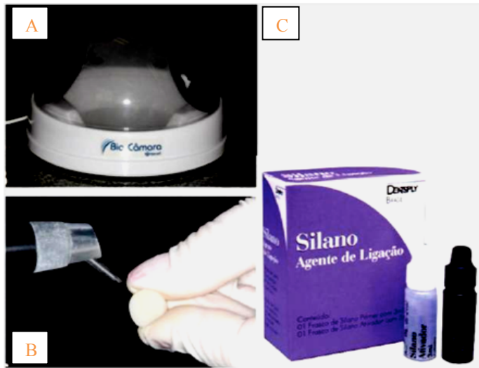
Figura 5 – A) Aparelho Microjato Bio-Art; B) Jateamento com partículas de óxido de alumínio com tamanho de 50 µm; C) Silano (Dentsply, Rio de Janeiro, Brasil)
