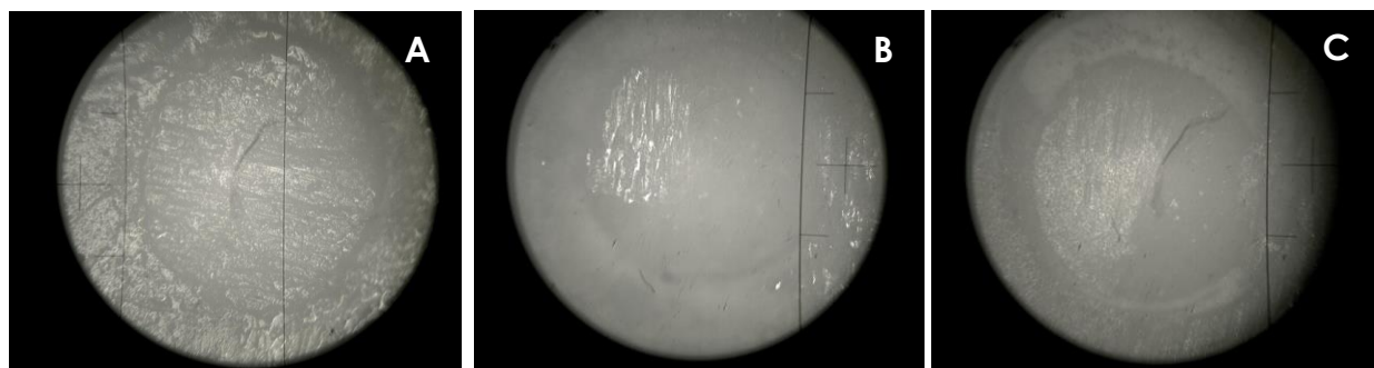
Figura 8. Imagens ilustrativas da interface de união fraturada nos grupos cimentados com Panavia F: (A) espécime com falha adesiva; (B) falha coesiva; (C) falha mista.
