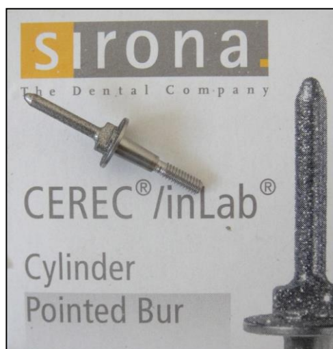
Figura 1. Ponta diamantada utilizada para a padronização da superfície cerâmica.
