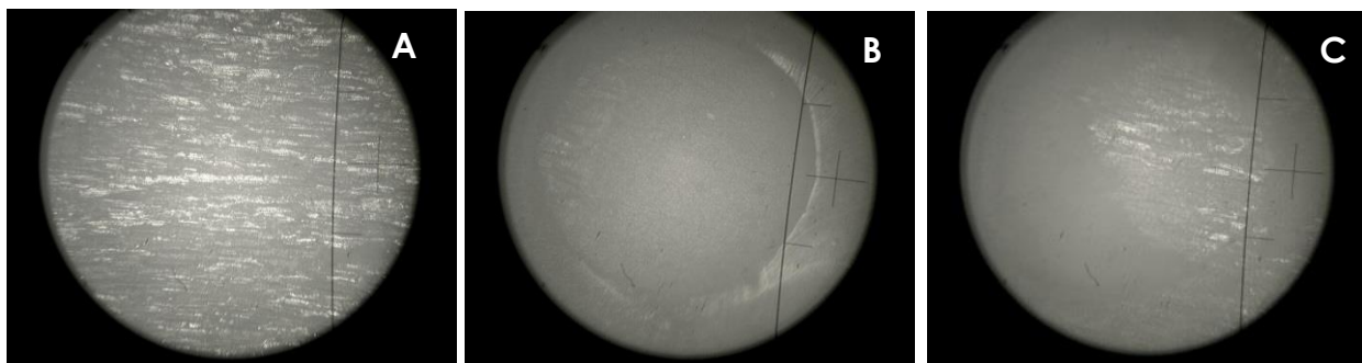
Figura 7. Imagens ilustrativas da interface de união fraturada nos grupos cimentados com RelyX ARC: (A) espécime com falha adesiva; (B) falha coesiva; (C) falha mista.
