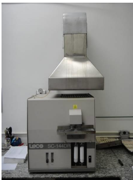
Figura 9: Equipamento CHNS-932 da LECO, modelo SC-144DR, para a determinação do carbono orgânico total, no Instituto de Geociências, UFRJ.
