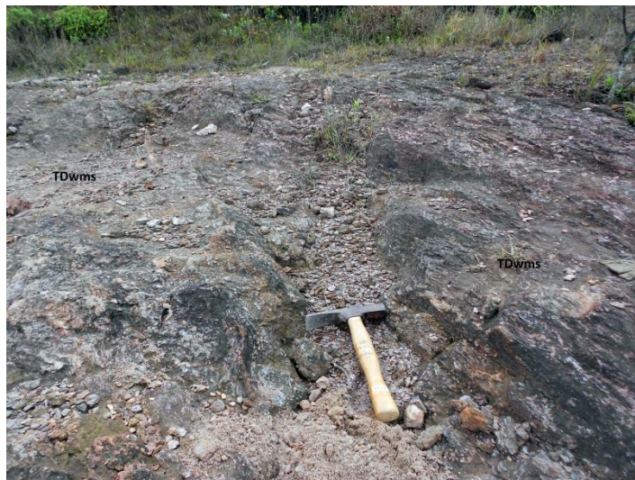
Figura 78 - TDwms apresentando desagregação superficial em área de corte em platô localizada próxima a rua Francisca Maria Vieira (foto de Vitorino, 2013).
