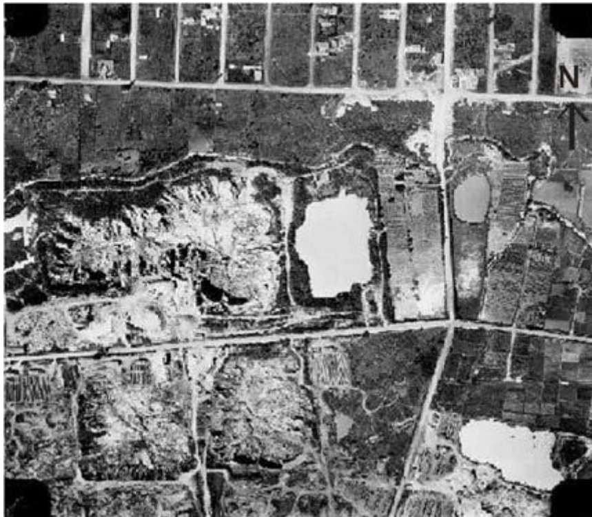
Figura 18: Foto aérea de 1.970, com visualização de cavas abandonadas pela exploração de areia, no rio Baquirivu-Guaçu. Bairro São João (33, Figura 1.5). Escala: 1:10.000. (PMG/SDUG, 2006).
