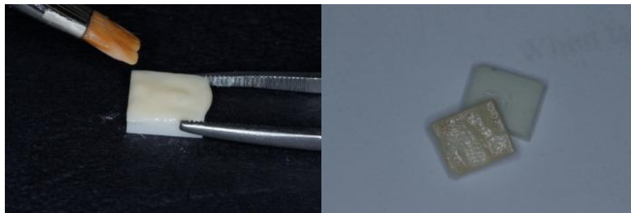
Figura 3. Aplicação do liner sobre as amostras de zircônia (A) e aspecto após remoção do forno (B).
