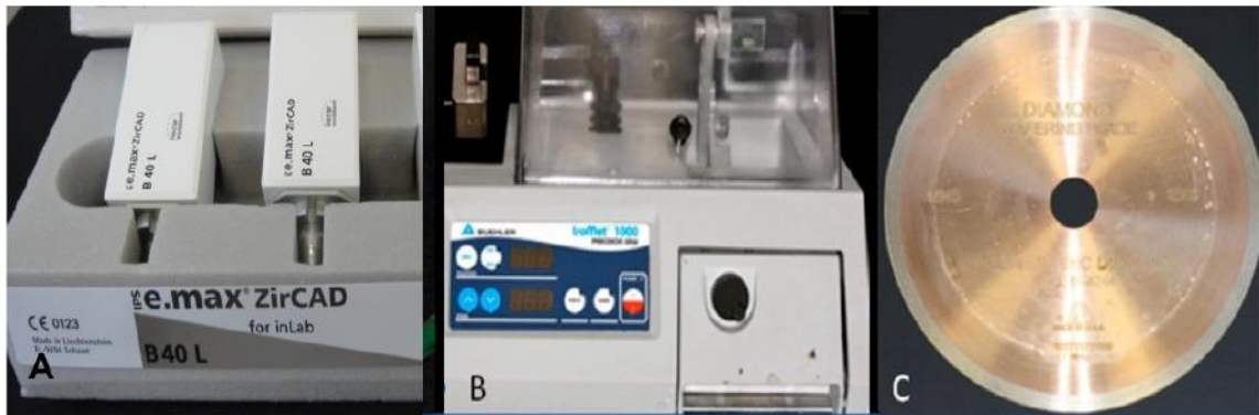
Figura 1. (A) emax ZirCAD (Ivoclar Vivadent, Schaan, Principado de Liechtenstein) (B) Cortadeira metalográfica (ISOMET 1000, Buehler, Lake Buff, IL, USA) (C) Disco diamantado (Series 15LC Diamond no 11-4254, Buehler, Lake Buff, IL, USA).
