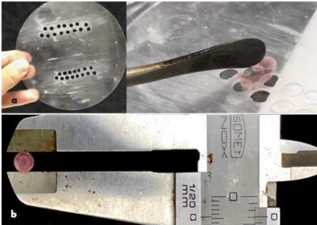
Figura 3- Moldes de acetato de 0,5 e 1mm de espessura e \varnothing 4mm vazadas com cera (a). Padrão em cera mensurado antes da inclusão em revestimento (b).
