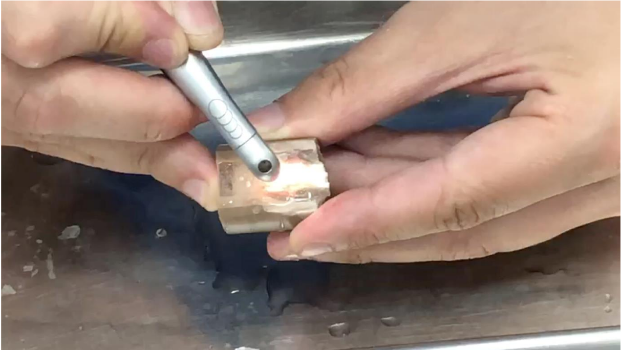
Figura 6- Posicionamento e aplicação do laser Er:YAG sobre as amostras.
