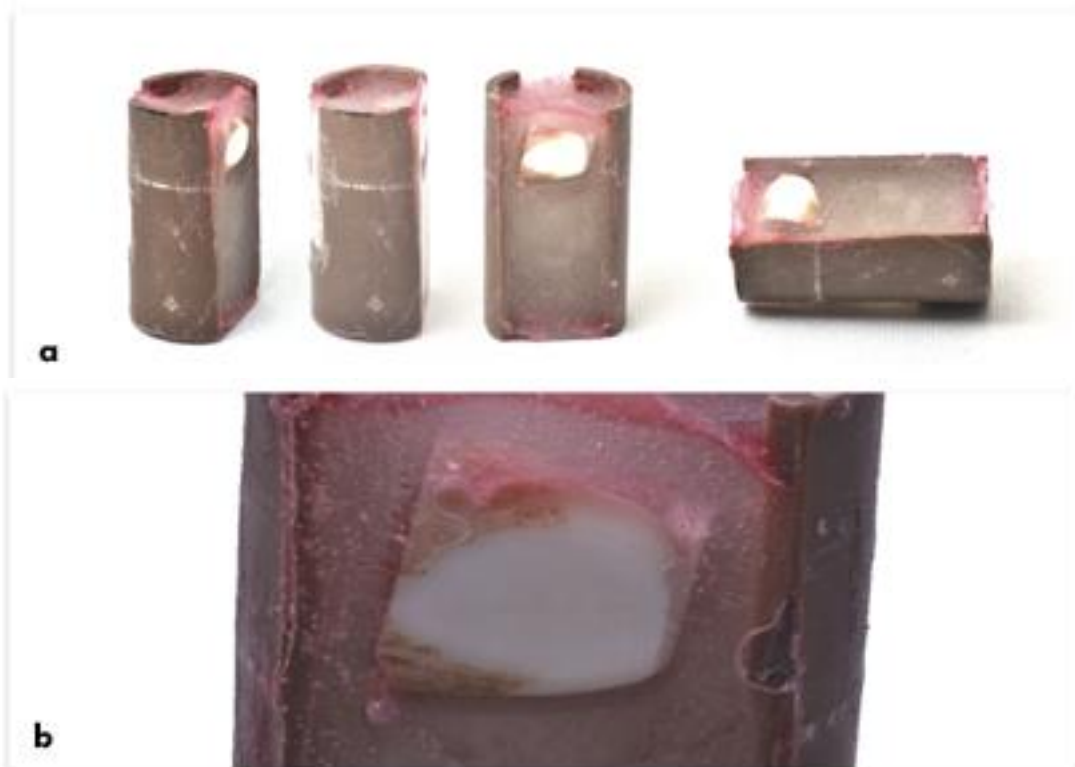
Figura 2- Coroas dos incisivos bovinos incluídas em tubos de PVC com resina acrílica termobatada (a). Detalhe aproximado da coroa polida com a sequência de lixas d'água (b).
